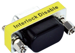
Interlock Disable Key 测试仪后部面板的互锁功能 (信号 输入) 配套钥匙
