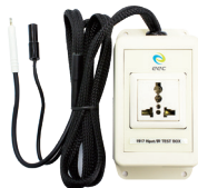
耐压绝缘测试治具盒 - 母端子 1.5 m 耐压和绝缘电阻测试夹具插座, 内 部火线和零线短接
